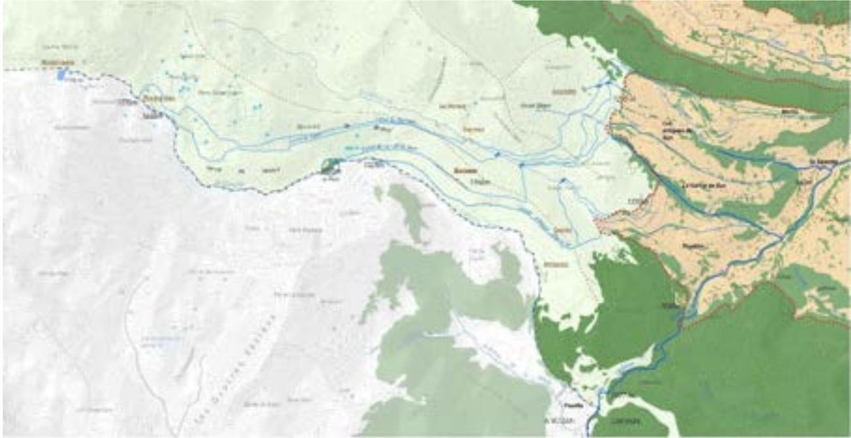
Relevé des canaux d'irrigation en moyenne montagne à Campan (Hautes-Pyrénées) de leurs prises d'eau aux rivières vers 1.700 mètres à leurs issues à 800 mètres d'altitude. Dévalant les estives entre 1.700 et 1.000 mètres, ces canaux irriguent ensuite par des rigoles les prés de fauche des terroirs. @ Julie Flambard / Ecole nationale supérieure d'architecture de Versailles – Ministère de la Culture 2020
