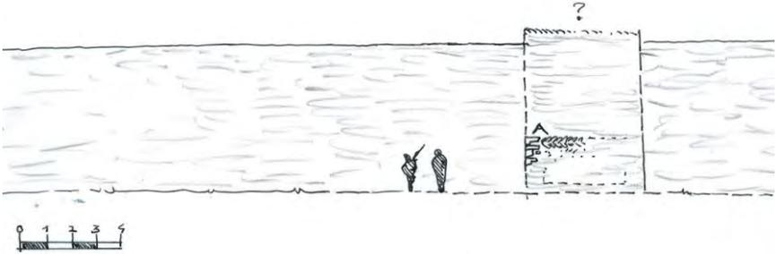
*Proposition d'une élévation du rempart vu depuis l'extra muros du côté du quartier d'Arras. A – Localisation du chaînage d'angle et de l'opus aretum relevés in situ. Cet appareil pourrait correspondre à un premier état bâti de la petite tour engagée dans le rempart. Les pierres du chaînage d'angle sont d'un calcaire très légèrement ocre clair et granuleux qui se distingue de la pierre de calcaire bleu généralement employée.*
